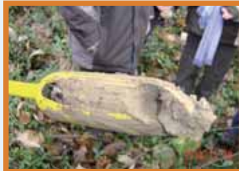
Gros plan sur le contenu de la tarière pédologique, prélèvement en profondeur : ici un sol argileux
